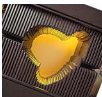
Figura 1: Sistema de colimação multilâminas utilizado na radioterapia conformacional. [15]
