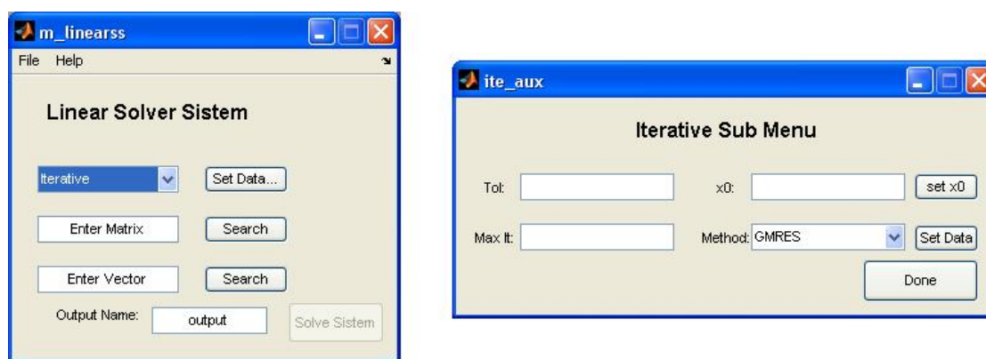
Figura 1: a janela da esquerda é responsável pelos dados básicos do problema; a janela da direita recebe dados para resoluções iterativas.
